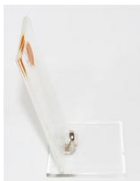
Glastafel wird in Halterung mit Kunststoff- schraube gestellt und justiert.
