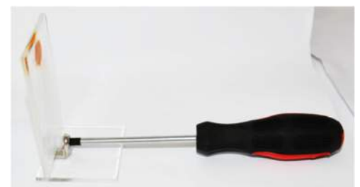
Mit einem Schraubendreher wird die Kunststoffschraube von hinten festgeschraubt.
